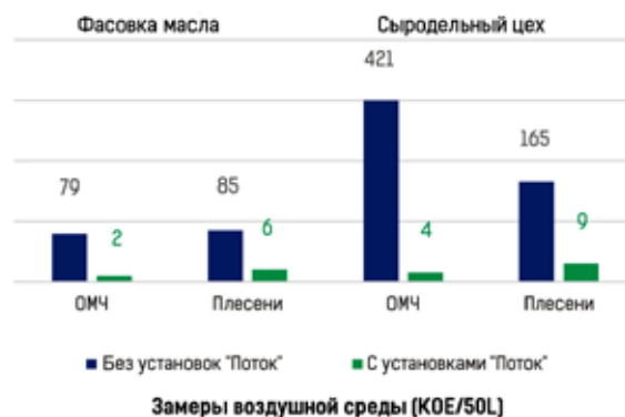
Рис. 9. Замеры воздушной среды в цехах пищевого предприятия для оценки эффективности установки «Поток»
